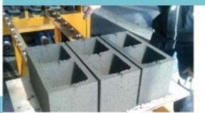
Acompañamiento en el desarrollo de la bloquera municipal, que tiene como misión la producción de **adoquines y bloques vibrados de hormigón**.
